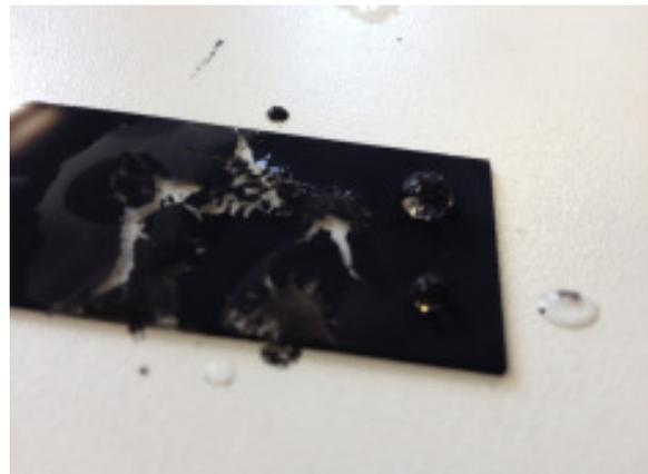
Zum letzten Bild: Bei diesem Experiment wurde ein Objektträger mit Hilfe einer Kerze rußgeschwärzt. Dadurch entstand eine Oberfläche mit der Eigenschaft Lotoseffekt. Nachdem die Oberfläche vollkommen gerußt war, haben die Schüler mit einer Pipette Wassertropfen auf den Objektträger getropft. Dabei konnten sie beobachten, dass die Wassertropfen abgeperlt werden. Außerdem wurde der Ruß, mit dem Wasser, von der Oberfläche „heruntergespült“.
